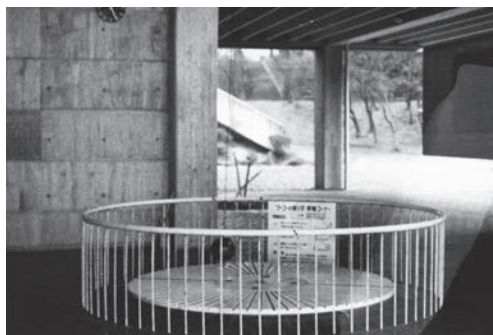
図21 新館建築時に入口ピロティに設置されたフーコー振子 (1967年頃)。吹き抜けの高い2階天井から吊るされていたが、1987年に松尾が着任した時には、すでに撤去されていた。
