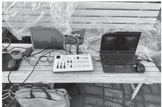
図10 屋外でのライブ配信機材の様子。夜露対策のため、ビニールを被せている。
