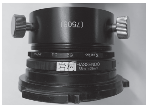
図4 2インチに対応した接眼部 下より Nikon既存アタッチメント(H60mmアイピースの土台)→58mmオス-58mmオスリング→52mm→58mmステップアップリング→BORG[7508]2インチアイピースホルダー
