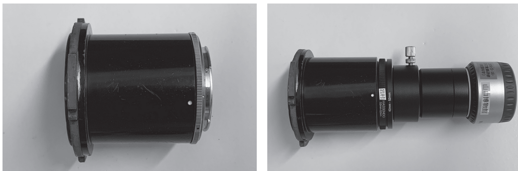
図3 既存の20cm屈折望遠鏡用直焦点用カメラアダプター(左)と改良した接眼部(右) カメラマウントを取り外し、土台→52mm(P=0.75)オス→52mm(P=0.75)オスリング→42mm-52mmステップアップリング→Tリングアイピースホルダー(Vixen製)
