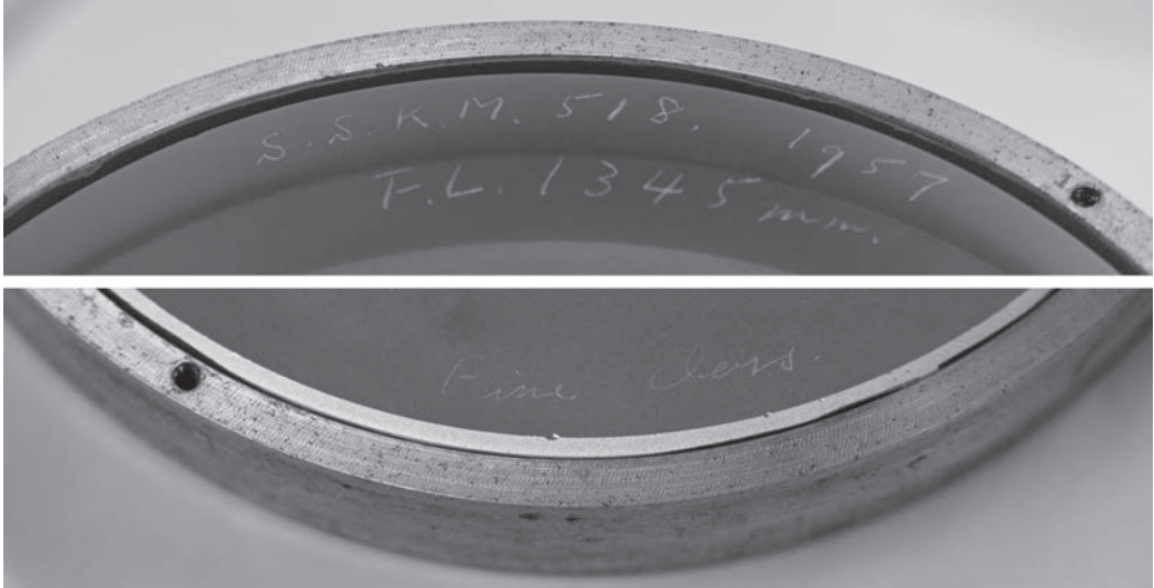
写真8 主鏡裏面 S.S.K.M. 518 1957 FL1345mm Fine Classと刻まれている
