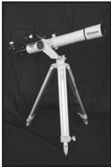
⑱屈折望遠鏡 Vixen 製 A80Mf 2006 年収蔵 口径 80mm 焦点距離 910mm 口径比 1:11.4 アロマート、マルチコーティング 経緯台
