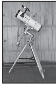
⑲反射望遠鏡 Vixen 製 2008 年収蔵 口径 130mm 焦点距離 650mm 口径比 1:5 GP 赤道儀 (2003 年) スカイセンサー 2000
