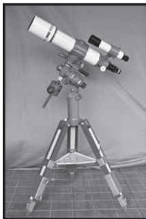
⑭屈折望遠鏡 高橋製作所製 1985 年収蔵 口径 76mm 焦点距離 600mm 口径比 1:7.9 フローライト (蛍石) システム P-2 赤道儀
