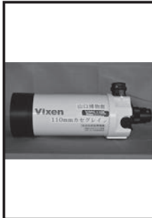
⑲カセグレン反射望遠鏡 Vixen 製 2008 年収蔵 口径 110mm 焦点距離 1035mm 口径比 1:9.4 球面鏡、マルチコーティング
