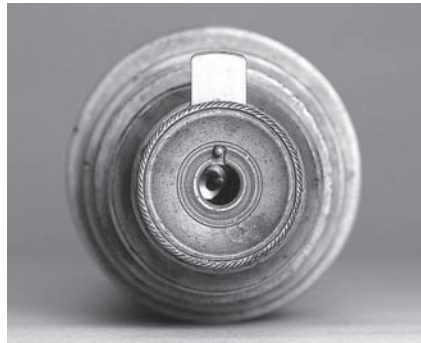
図5 シャッター機構とローレット加工。左写真が対物部、右写真が接眼部
