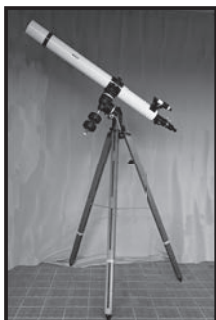
⑪屈折望遠鏡 日本光学工業 (Nikon) 製 1973 年収蔵 口径 80mm 焦点距離 1200mm 口径比 1:15 アクロマート 赤道儀
