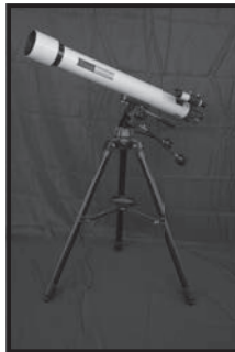
⑯屈折望遠鏡 Vixen 製 New・ICARUS D-80M 2004 年収蔵 口径 80mm 焦点距離 910mm 口径比 1:11.4 経緯台
