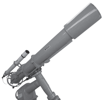
⑨屈折望遠鏡 日本光学工業 (Nikon) 製 No.2002 1967 年収蔵 口径 200mm 焦点距離 2400mm 口径比 1:12 鏡筒 300cm ドイツ式赤道儀 (赤経軸微動駆動) No.1009 屋上ドーム (5m) 内に設置 ファインダー: 16.5×50 サブスコープ: Nikon80mm 屈折望遠鏡 アストロカメラ、周波数可変装置、光電測光装置、 太陽投影装置、接眼分光器
