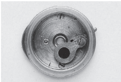
図1 ゾングラスの機構(接眼部内側)
