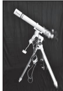
⑳屈折望遠鏡 Vixen 製 A80M 2008 年収蔵 口径 80mm 焦点距離 910mm 口径比 1:5 SPHINX 赤道儀 STARBOOK
