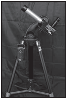
㉑太陽望遠鏡 (屈折) コロナド製 2011 年収蔵 口径 40mm 焦点距離 400mm 口径比 1:10 経緯台 (自動導入) AUTOSTAR
