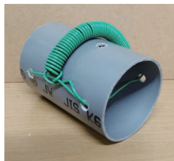
写真4 コイルを装着した塩ビパイプ
